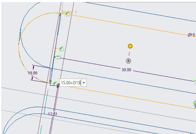
**Рис. 4. Зависимость размеров шпоночного паза и шпонки**
