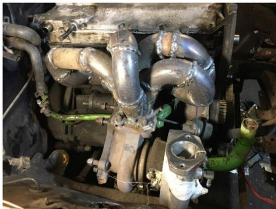
**Рис. 1. Подключение турбокомпрессора**
