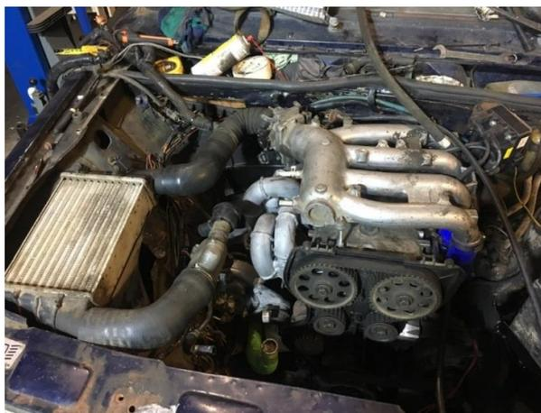
**Рис. 2. Установленный модифицированный двигатель ВАЗ 2112 в автомобиле ВАЗ 2101**
