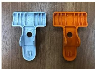
**Рис. 2. Типовая деталь для сканирования и её прототип**
